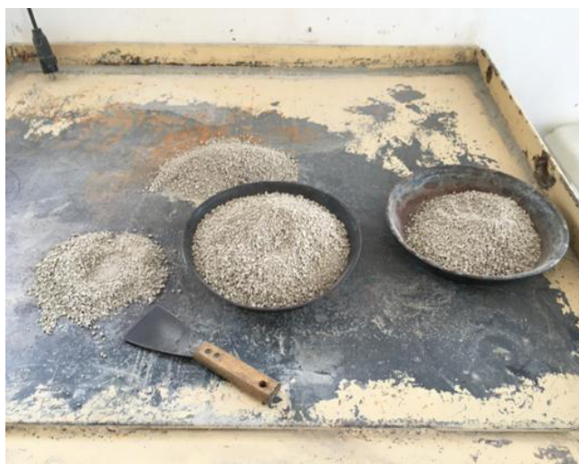
شکل ۷: سنگدانه ریز بتن باز یافتی استفاده شده در این تحقیق
