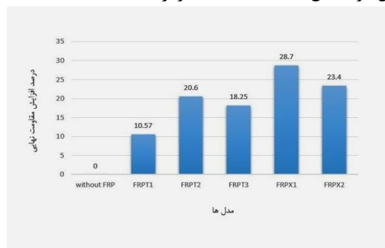
شکل (۵-۱) مقایسه مقاومت نهایی اتصالات تقویت شده
