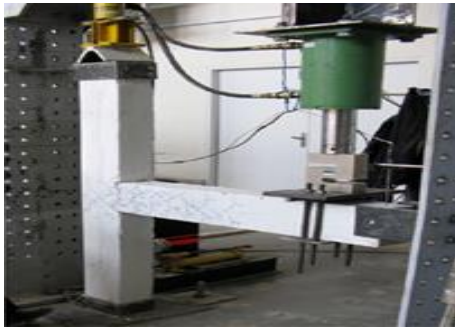
شکل (۱-۳) جزییات هندسی اتصال بتنی مورد مطالعه در مقاله مرجع [۱۴] شکل (۲-۳) روش بارگذاری سیکلیک اتصال بتنی در مرجع [۱۴]
