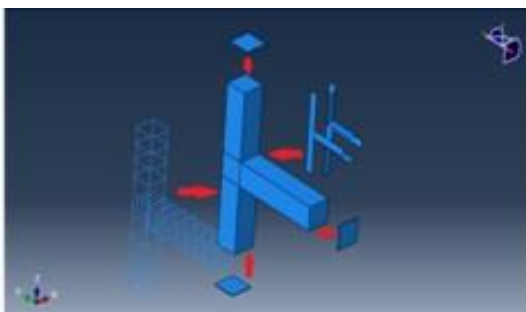
شکل (۳-۱۲) مدل سازی هندسی اجزاء مختلف و فرایند مونتاژ مدل نهایی
