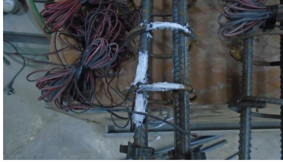
شکل (۶) تصویری از نصب حسگرهای الکتریکی بر انواع میلگردهای طولی و عرضی ستون
