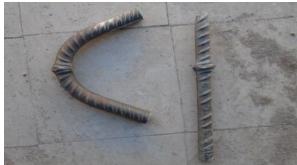
شکل (۵) میلگردهای با جوش سر به سر پس از آزمایش خمش و کشش
