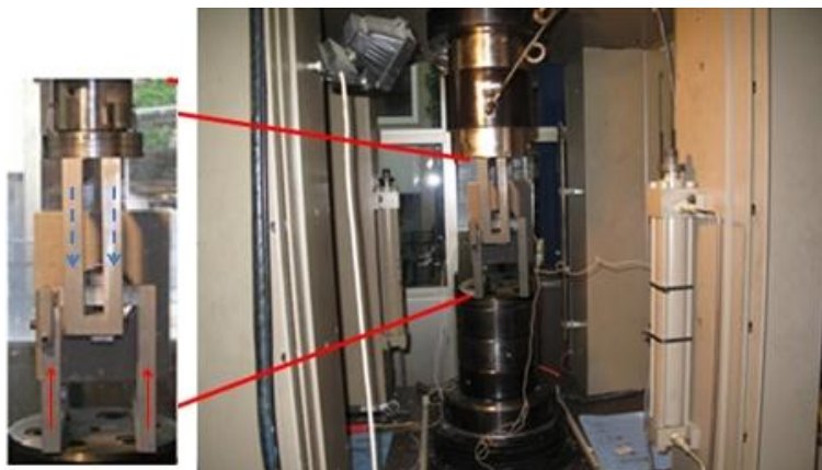
شکل ۶- دستگاہ بارگذاری فشاری و نحوه بارگذاری نمونه.
