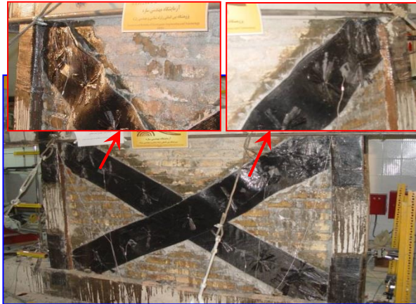
شکل ۹- قاب بتنی دارای میانقاب میان پر که با کامپوزیت FRP تقویت شده
