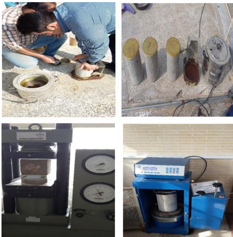
شکل ۴- نحوه کلاhek گذاری و انجام آزمایش فشاری نمونه‌ها
