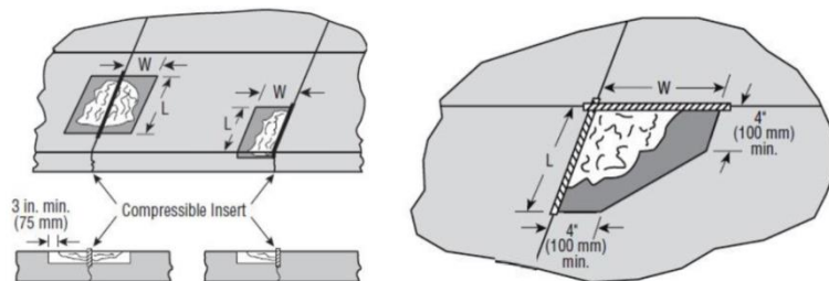
شکل ۱۱ - مطالعه و تعیین محدوده خرابی و نیز محدوده ترمیم (بیش از محدوده خراب)
