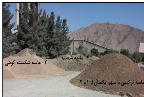
شکل ۲ - ماسه شکسته کوهی، شسته، ترکیبی (راست) - منحنی دانه بندی ریزدانه و محدوده ریزدانه مطابق مرجع [۷] (چپ)
