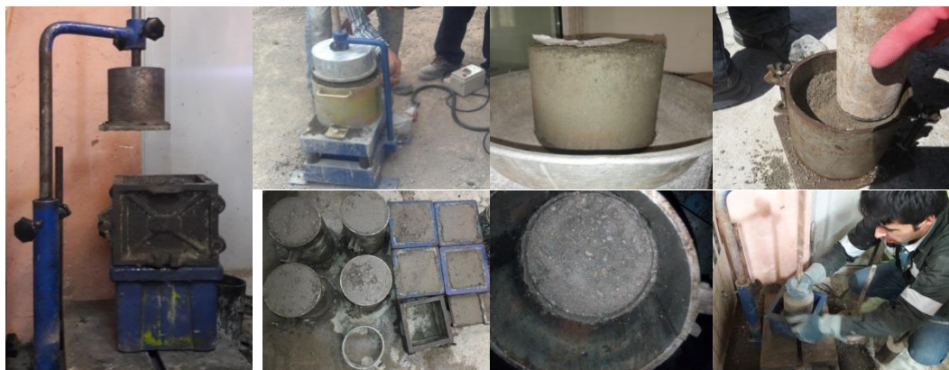
شکل ۴ - آزمایش تراکم اصلاح شده و تعیین چگالی خشک ماکزیمم، زمان وی بی اصلاح شده، و تهیه نمونه از RCC در آزمایشگاه
