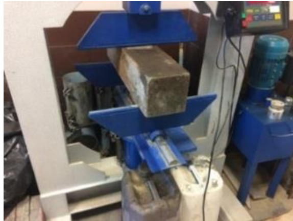
شکل (۹) - آزمایش مقاومت خمشی
