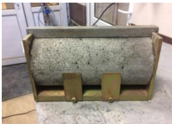
شکل (۸) - آزمایش مقاومت کششی برزیلی
