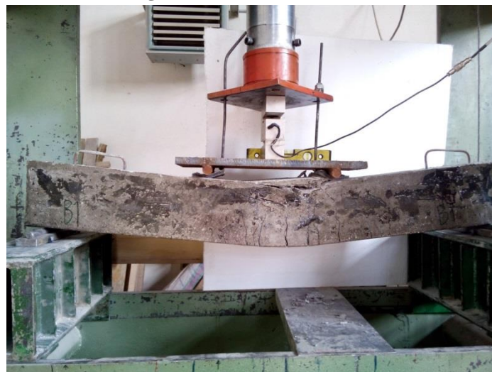
شکل ۲-۷) تیر B1 پس از انهدام
