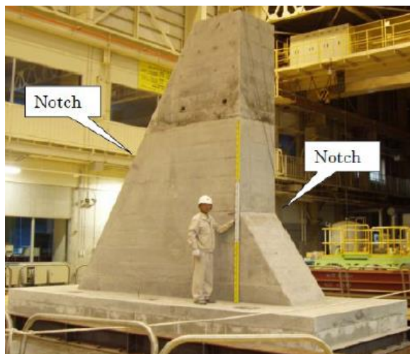
شکل ۱: تصویر مدل سد در مقیاس بزرگ
