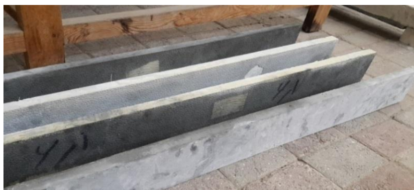
شکل ۲ پانل‌های پیش ساخته UHPFRC
