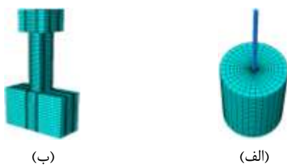
شکل ۳: پیکربندی مش‌بندی سازه‌ها: (الف) نمونه تست بیرون کشیدگی و (ب) ستون بتنی.
