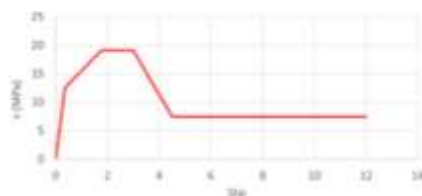
شکل ۸: تعریف رابطه تنش - لغزش پیوند بین میلگردهای GFRP و بتن مطابق با مدل ساختاری پیشنهادی در این مطالعه.
