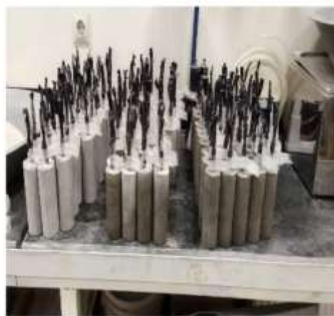
شکل ۴: آماده‌سازی آزمون‌های حاوی آرماتور جهت آزمایش نیم پیل
