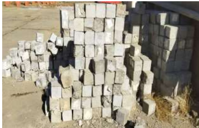
شکل ۱: تبدیل آزمون‌های بتنی به سنگدانه از طریق خردایش
