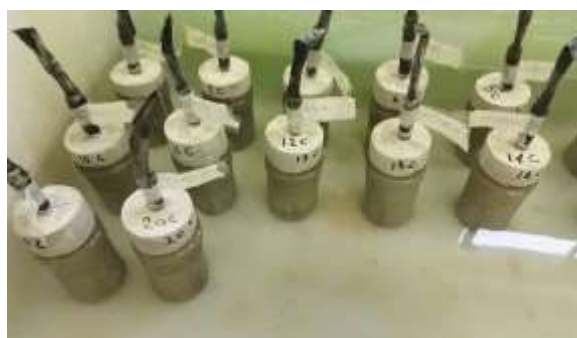
شکل ۵: قراردادن آزمون‌های آزمایش نیم‌پیل در محلول ۱۰ درصد NaCl
