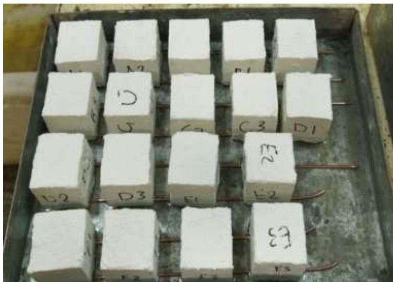
شکل ۳: آماده‌سازی آزمونه‌ها جهت انجام آزمایش جذب آب موئینه
