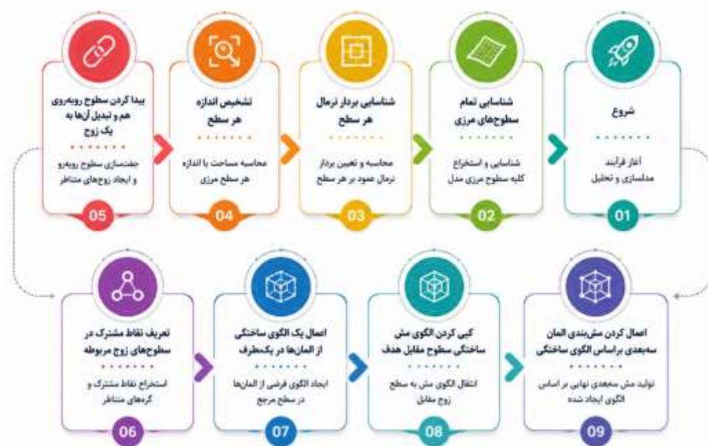
شکل ۸- فلوچارت ماژول کپی‌مش و تکنیک المان ساختگی برای تولید مش متشابه در جوه روبروی هم برای RVEهای سه بعدی پرئودیک (متناوب)
