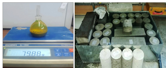
شکل (۴) - طرز عمل آوری و نگهداری نمونه های بتنی در حوضچه ی آب و آزمایش وزن مخصوص سیمان
