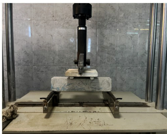
شکل ۱. مراحل آزمایش مدول گسیختگی (مقاومت خمشی) تیر بتنی
