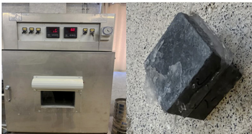
شکل ۲. نمونه آزمایشگاهی تحت چرخه های ذوب و یخبندان
