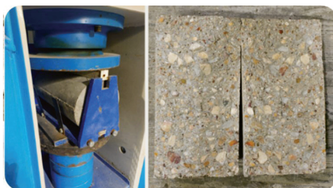
شکل ۱۲ تصویری از آزمایش مقاومت کشش برزیلی
