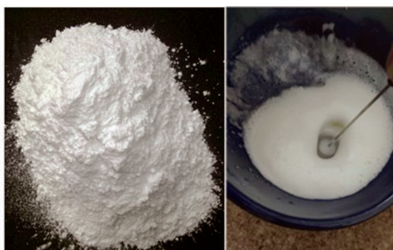
شکل ۳ نمایی از پودر نانو اکسید آلومینا (تصویر چپ) و تهیه محلول نانو اکسید آلومینا با ابرروان کننده پیش از افزودن به بتن (تصویر راست)
