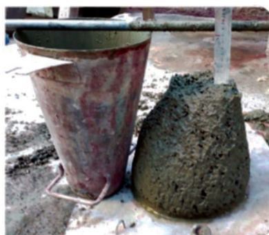
شکل ۵ تصویری از آزمایش اسلامپ
