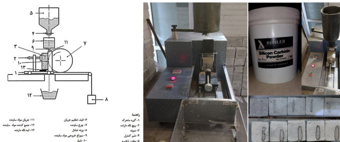
شکل ۱۴ تصویری از آزمایش مقاومت سایشی بتن
