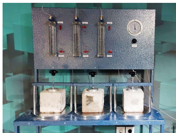
شکل ۱۷ تصویری از آزمایش نفوذ آب در بتن
