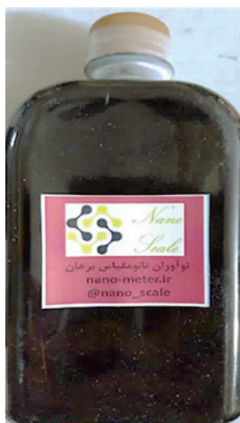
شکل ۴ نانو کلونید اکسید گرافن مورد استفاده
