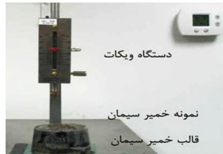
شکل (۲) اجزای اصلی دستگاه سوزن ویکات مطابق با استاندارد ASTM C191
