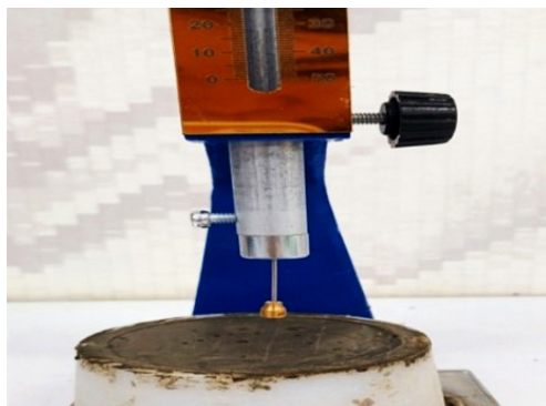
شکل (۳) روند انجام آزمون و تعیین زمان گیرش اولیه و نهایی با دستگاه ویکات
