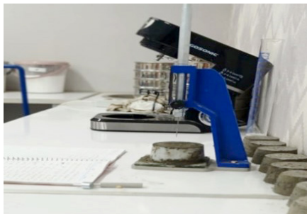
شکل (۲) اجزای اصلی دستگاه سوزن ویکات مطابق با استاندارد ASTM C191
