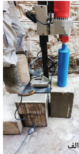
شکل ۱. الف) عملیات مغزه‌گیری از ستون بتنی (ب) عمل‌آوری آزمونه‌های مرطوب
