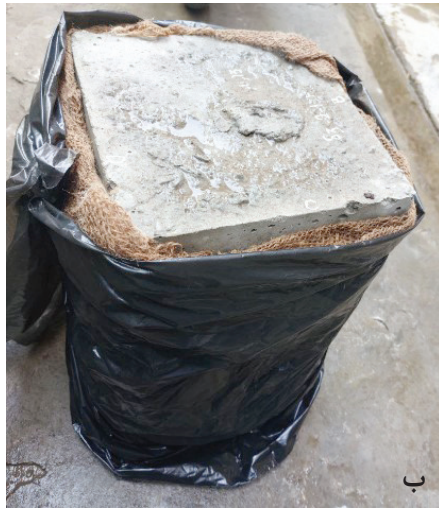
شکل ۱. الف) عملیات مغزه‌گیری از ستون بتنی (ب) عمل‌آوری آزمونه‌های مرطوب
