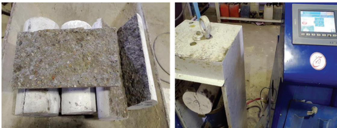
شکل ۱۴: یک نمونه بتنی حین و بعد از آزمایش مقاومت کششی (دو نیم شدن)
