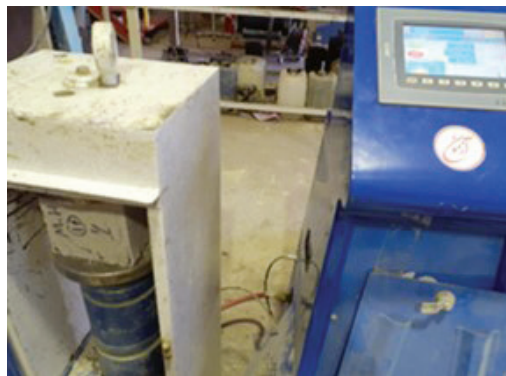
شکل ۱۰: یک نمونه بتنی حین آزمایش مقاومت فشاری
