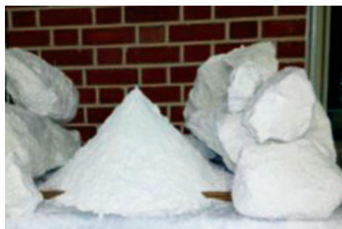
شکل ۴. تکه‌های دیاتومیت و پودر دیاتومیت مصرفی در ساخت نمونه‌های این پژوهش
