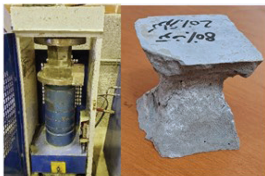
شکل ۴: آزمونه ساخته شده از طرح مخلوط T80، حین و پس از آزمایش مقاومت فشاری
