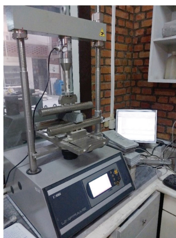
شکل ۸ - نمونه تیر خمشی در حین آزمون خمشی
