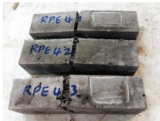
شکل ۶ - تیرهای خمشی حاوی یک نوع الیاف
