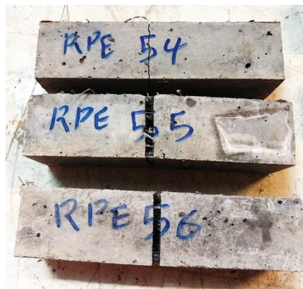
شکل ۷- تیرهای خمشی حاوی دو نوع الیاف
