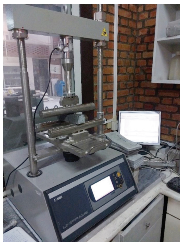
شکل ۸- نمونه تیر خمشی در حین آزمون خمشی
