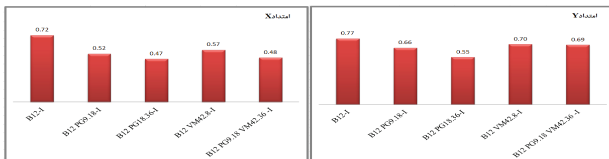
نمودار ۱۲. میزان کاهش برش پایه مدل‌های ۵ طبقه جداسازی شده در پایه نسبت به حالت گیردار در امتداد محورهای X و Y
