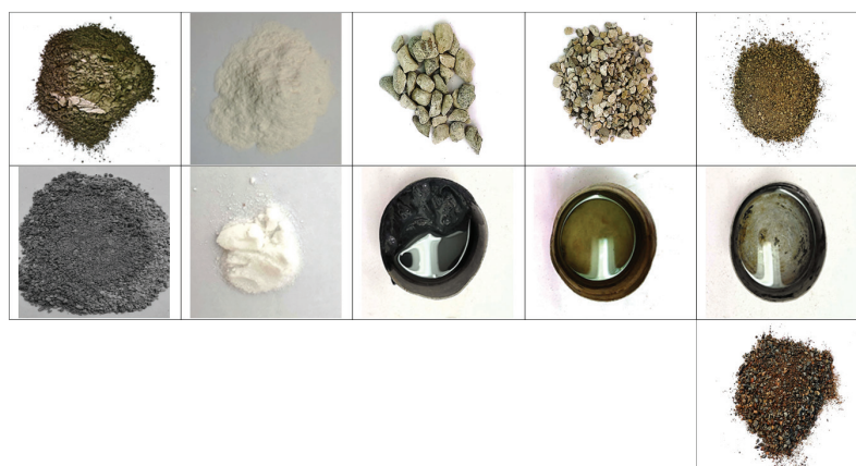
شکل ۵ - مصالح مورد مصرف در طرح اختلاط بتن خودتراکم (۱- ماسه، ۲- شن نخودی، ۳- شن بادامی، ۴- پودر سنگ، ۵- سیمان، ۶- آب، ۷- فوق روان کننده، ۸- زل نانو سیلیس، ۹- افزودنی اصلاح کننده ویسکوزیته، ۱۰- خرده بلوک سیمان، ۱۱- ضایعات ساختمان)
