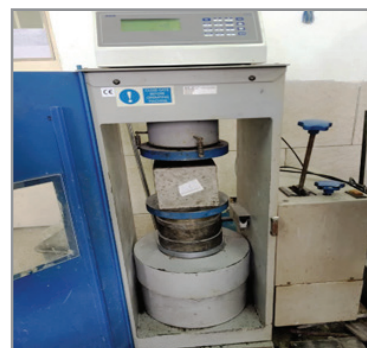
شکل ۱۱ - الف) شکست نمونه مکعبی با دستگاه مقاومت فشاری ب) نتایج داده‌های آزمایش مقاومت فشاری نمونه‌های مکعبی
