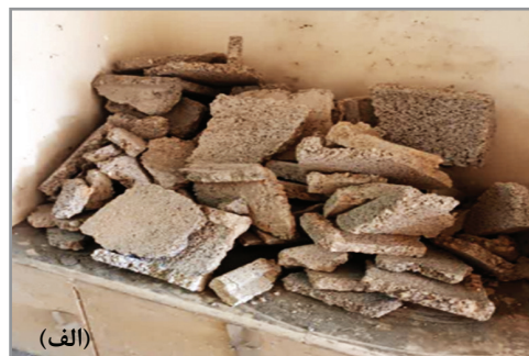
شکل ۲ - الف) بلوک سیمانی ب) دانه‌بندی خرده بلوک سیمانی
