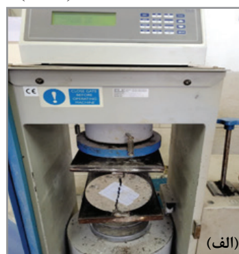
شکل ۱۲ - الف) شکست نمونه استوانه‌ای با دستگاه مقاومت کششی (برزیلی) ب) نتایج داده‌های آزمایش مقاومت کششی نمونه‌های استوانه‌ای
