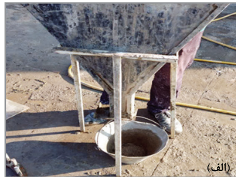
شکل ۷ - الف) آزمایش قیف V (ب) نتایج آزمایش قیف V
