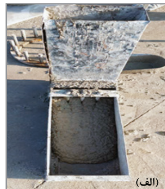
شکل ۸ - الف) آزمایش جعبه L (ب) نتایج آزمایش جعبه L
