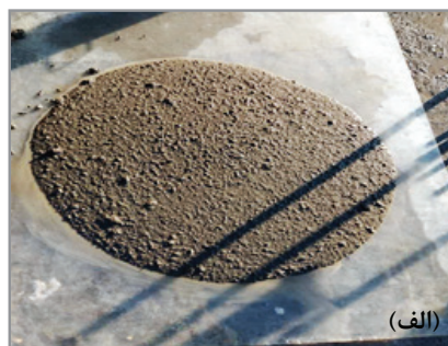
شکل ۶ - الف) آزمایش جریان اسلامپ ب) نتایج آزمایش جریان اسلامپ
