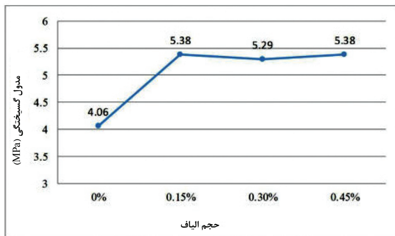
شکل ۱۳- تاثیر الیاف پلی پروپیلن بر مدول گسیختگی
