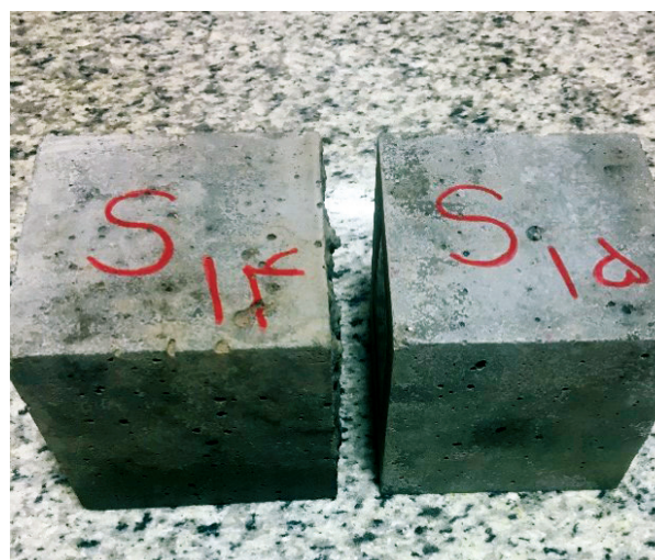
پ) نمونه‌های بتن سبک اسکوریا قبل از قرار گیری در محیط اسیدی
