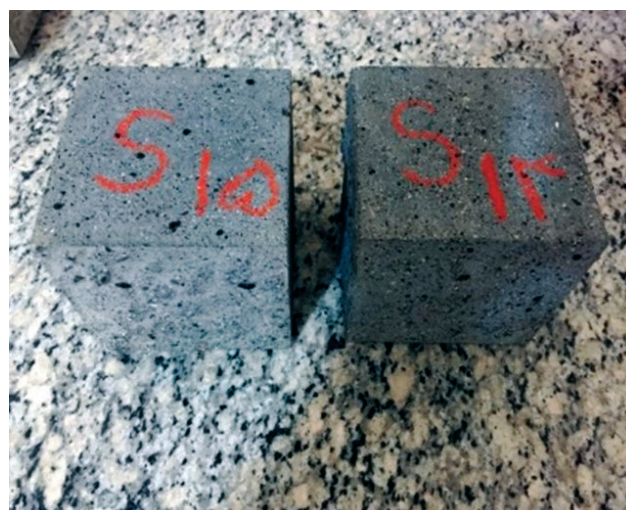
ت) نمونه‌های بتن سبک اسکوریا بعد از قرار گیری در محیط اسیدی
