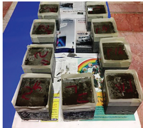
الف) کپینگ کردن نمونه‌ها
