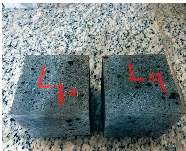
ب) نمونه‌های بتن سبک لیکا بعد از قرار گیری در محیط اسیدی
