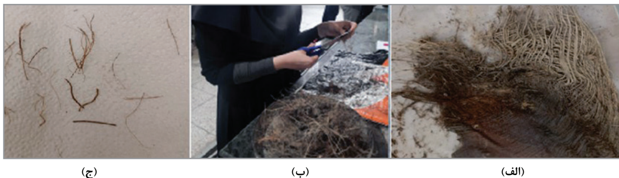
شکل (۲): الیاف نخل خرما: (الف) الیاف دور تنه درخت نخل خرما؛ (ب) الیاف پس از جداسازی از تنه درخت؛ (ج و د) الیاف رشته‌ای
