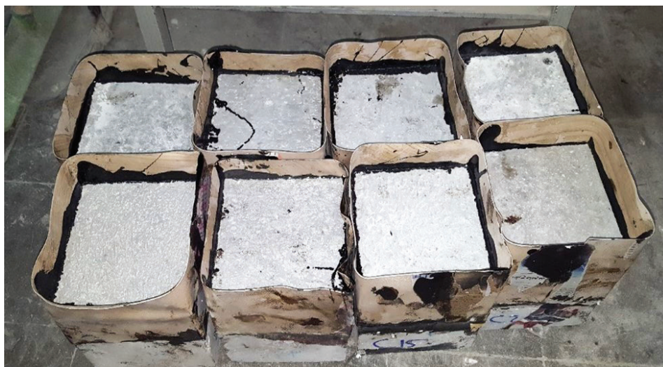
شکل ۳: آزمونه‌های بتنی آماده شده برای آزمون پوسته شدن در مجاورت نمک یخ‌زدا
