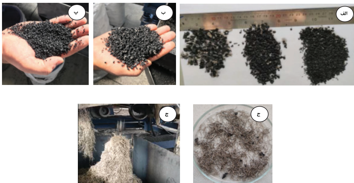
شکل ۲- تصاویر مصالح بازیافتی لاستیک فرسوده (الف، ب و پ: خرده لاستیک در سه اندازه مختلف ج: الیاف فلزی چ: الیاف نخی بازیافتی)
