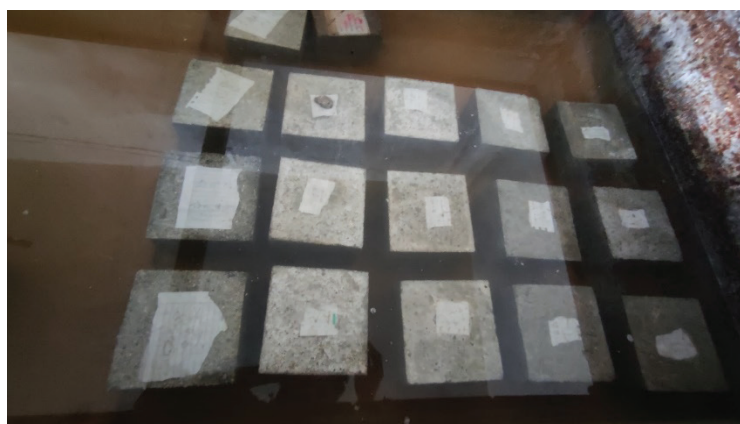
تصویر ۵- قرار گرفتن نمونه‌ها در حوضچه آب
