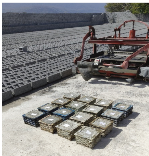
تصویر ۴- قالب‌های پر شده از ملات‌های مورد نظر پس از یک روز
