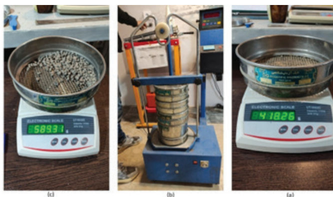
تصویر ۱- (a). اندازه گیری وزن الک قبل از اعمال لرزش. (b). قرارگیری الکها بر روی شیکر. (c). اندازه‌گیری وزن الکها پس از اعمال لرزش.
