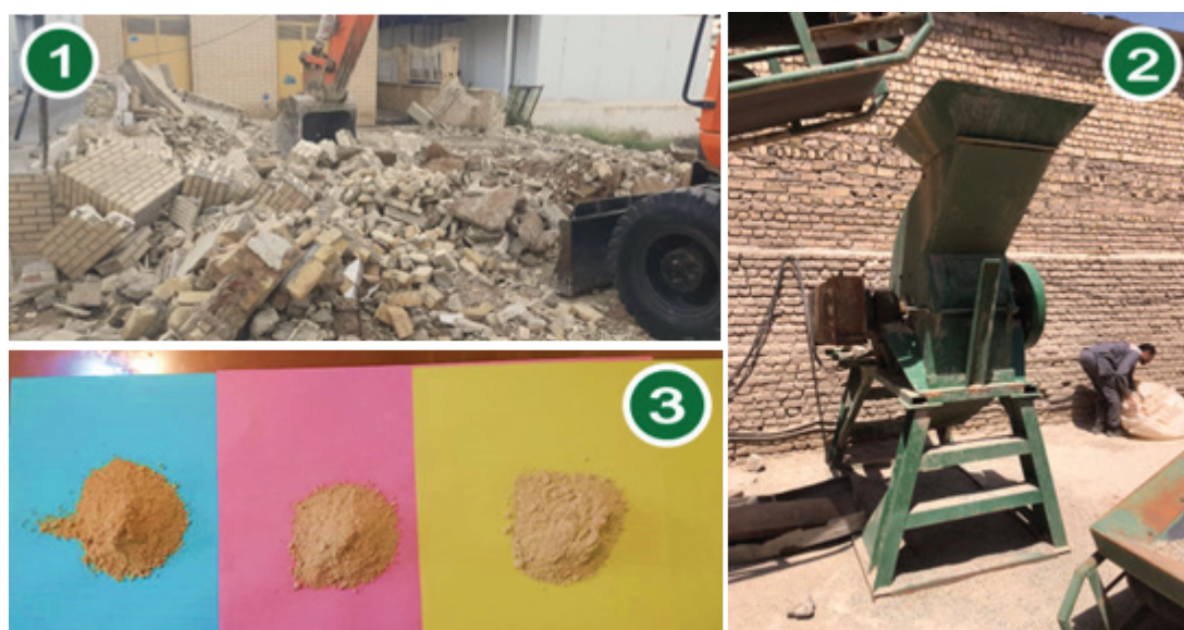
شکل ۲ - روند بازیافت آجر ضایعاتی و تبدیل آن به پودر آجر در این تحقیق
