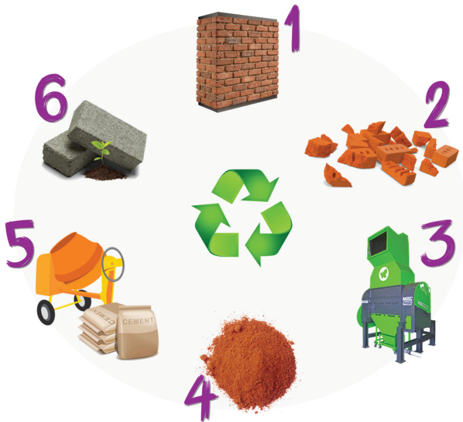
شکل ۶ - فرآیند برنامه آزمایشگاهی ساخت بتن سبز با پودر آجر بازیافتی
