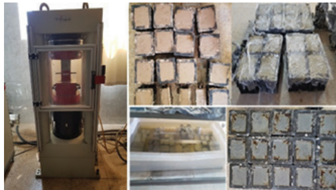
شکل ۳- مراحل ریختن، عمل‌آوری ملات‌ها و دستگاه آزمایش
