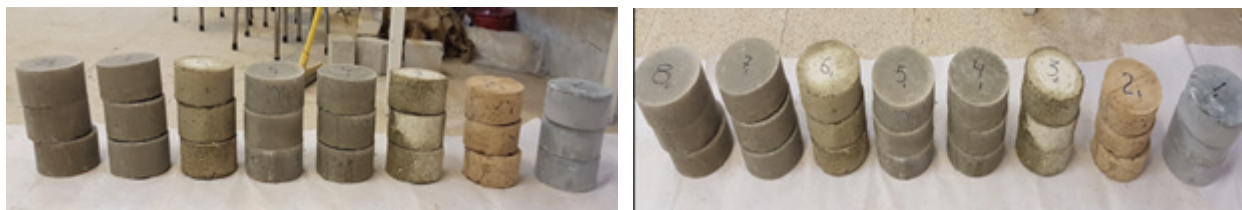
شکل ۶- نمونه‌های آزمایشی ملات سیمانی، رسی و ژئوپلیمری مقاومت ضربه
