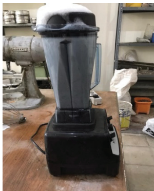
شکل ۱- تولید کف بالا در فرآیند تهیه محلول گرافن برای نسبت G/S > 1
