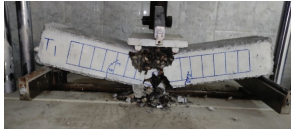
شکل ۱۰- نحوه شکست تیرهای بتن آرمه حاوی سرباره
