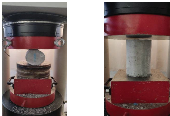
الف- آزمایش نمونه فشاری ب- آزمایش نمونه کششی
