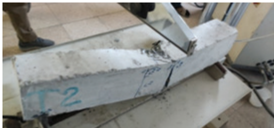
شکل ۱۰- نحوه شکست تیرهای بتن آرمه حاوی سرباره
