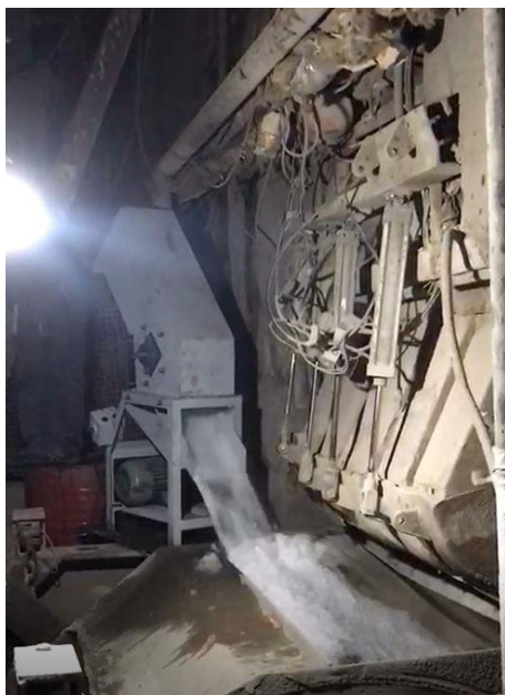
شکل ۳- نحوه افزودن یخ به مخلوط بتن در دیگ مخلوط‌کن
