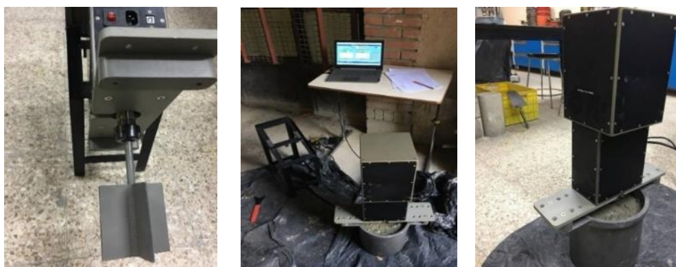
شکل ۷- دستگاه رئومتر به کار برده شده جهت تعیین خواص رفتارشناسی ملات (قطر و ارتفاع پره بدون میله متصل به آن)، هر دو، برابر ۱۰ سانتی‌متر می‌باشند و قطر سطل فلزی نیز برابر ۲۰ سانتی‌متر می‌باشد.
