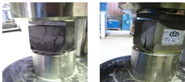
شکل ۵: نمونه ساخته شده از PRC بعد از انجام آزمایش مقاومت فشاری
