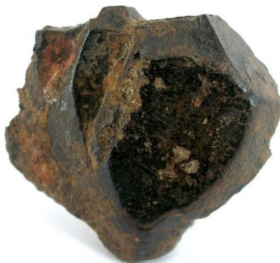
شکل ۲ سنگدانه خالص و طبیعی ایلمنیت (فرآوری نشده) [۲۳]
