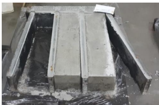
شکل ۱: نمونه خمشی تهیه شده در قالب خمشی ۴۰×۴۰×۱۶۰ میلی‌متری.
