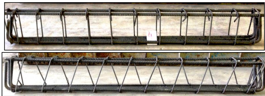
شکل ۱: خاموت گذاری بسته متداول و خاموت گذاری مارپیچ پیوسته نمونه های آزمایشگاهی
