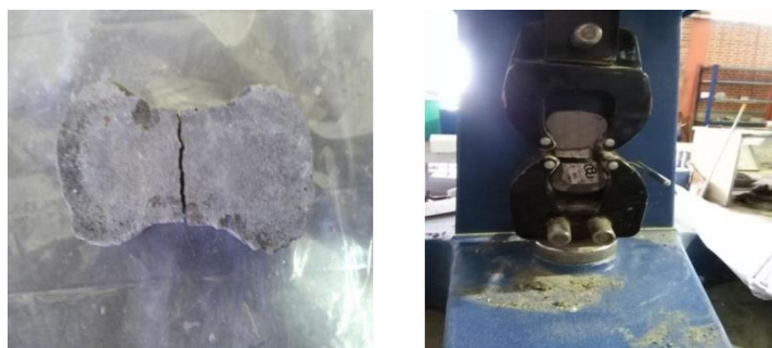
شکل ۱۰: نمونه ساخته شده از PRC بعد آزمایش مقاومت کششی
