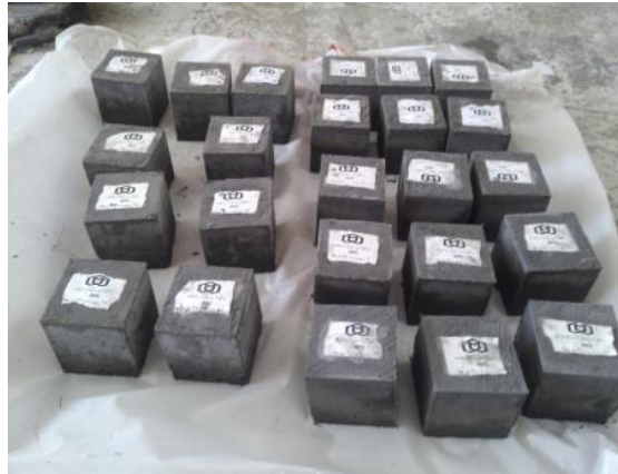
شکل ۴: بخشی از نمونه‌های ساخته شده از PRC برای آزمایش مقاومت فشاری
