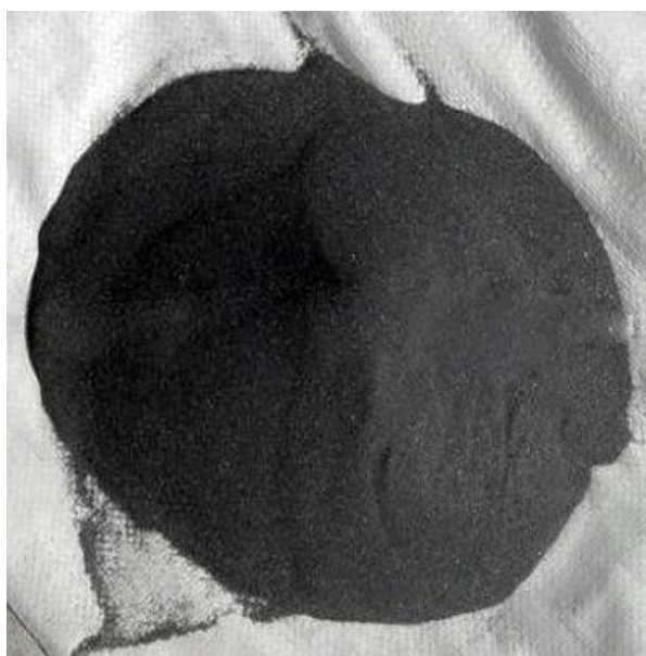
شکل ۶ ایلمنیت مورد استفاده جهت ساخت بتن سنگین
