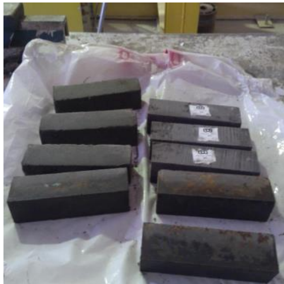
شکل ۳: نمونه‌های ساخته شده از PRC برای آزمایش مقاومت خمشی در حالت اشباع با سطح خشک
