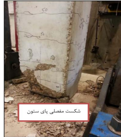
الف) نوع شکست مفصلی در محیط آزمایشگاه [1]
