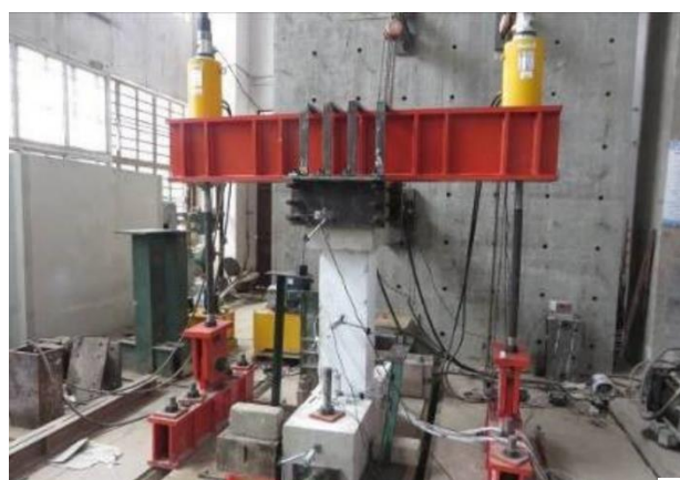
شکل ۴ ستون کوتاه تحت بارگذاری جانبی در مطالعه آزمایشگاهی [۱]
