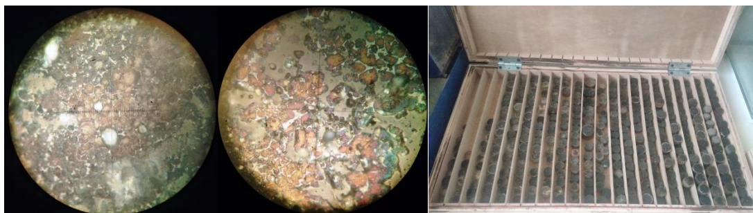
شکل ۳- انجام مطالعات میکروسکوپی بر روی نمونه‌های کلینکر
