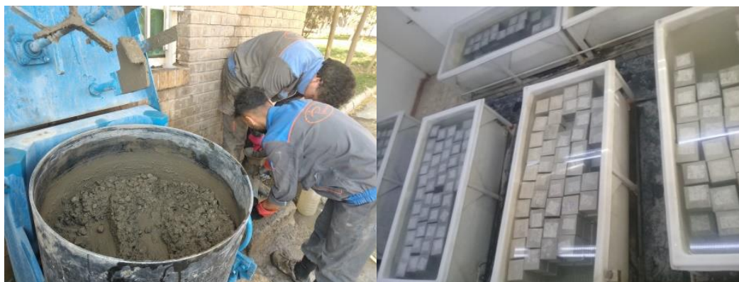
شکل ۵-انجام آزمایش بر روی مخلوطهای بتنی
