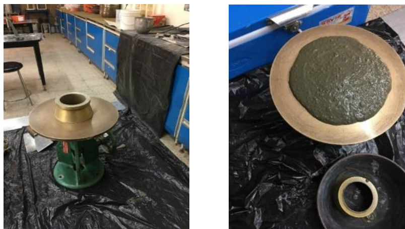
شکل ۶- میز جریان و مخروط ناقص کوچک در شکل سمت چپ و بازشدگی ملات روی میز جریان با برداشتن مخروط ناقص کوچک در شکل سمت راست
