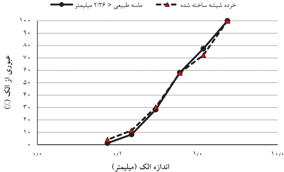
شکل ۲- نمودار دانه‌بندی ماسه طبیعی کوچکتر از ۲/۳۶ میلیمتر و خرده شیشه‌های ساخته شده
