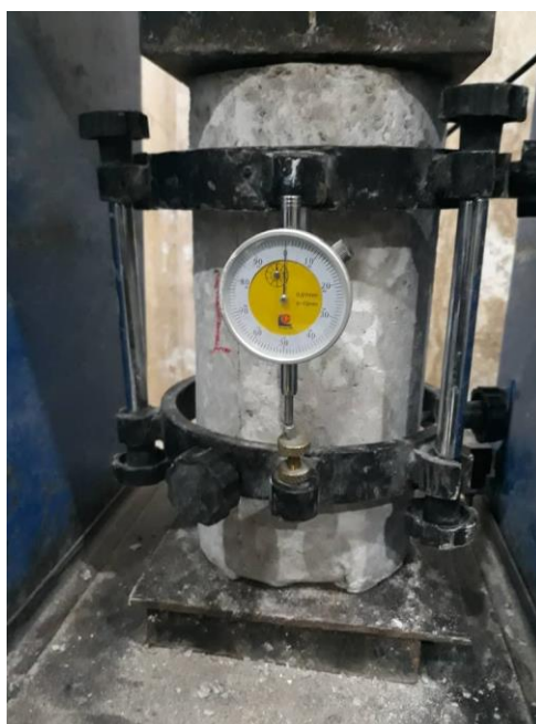
شکل ۳- نمونه بتنی در حال انجام آزمون مدول الاستیسیته
