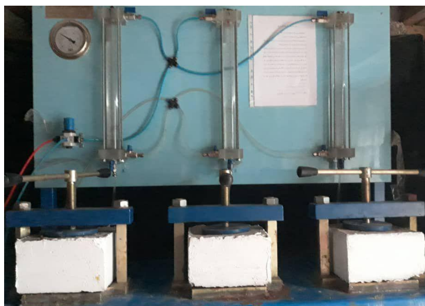
شکل ۶- آزمون نفوذپذیری آب در بتن
