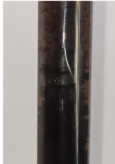
شکل ۵: پراکندگی MWCNT اکسید شده
