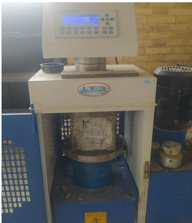
شکل ۱۵. آزمایش مقاومت فشاری نمونه مکعبی بتن
