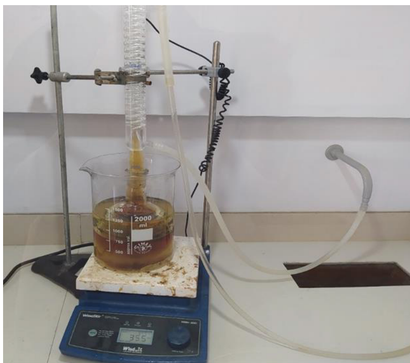
شکل ۳. حمام پارافین محلول MWCNT به همراه نیتریک اسید و سولفوریک اسید نصب شده در زیر هود آزمایشگاهی
