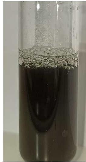
شکل ۷: پراکندگی MWCNT اکسیدشده حاوی CTAB بعد از ۹۰ دقیقه شکل ۸: پراکندگی MWCNT اکسیدشده حاوی CTAB بعد از یکماه
