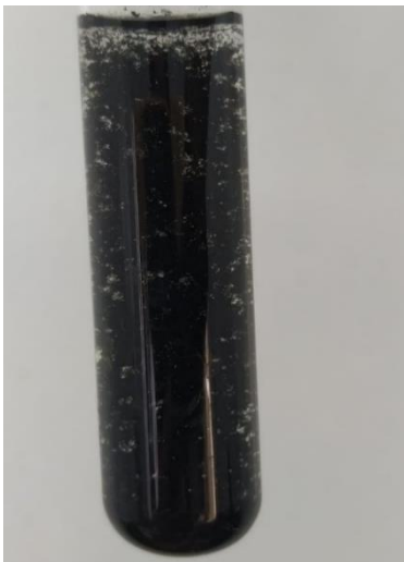
شکل ۶: پراکندگی MWCNT اکسید شده حاوی SDS
