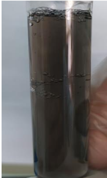
شکل ۱۰: پراکندگی MWCNT اکسیدشده حاوی PEG/PCE رقیق شده بعد از یکماه
