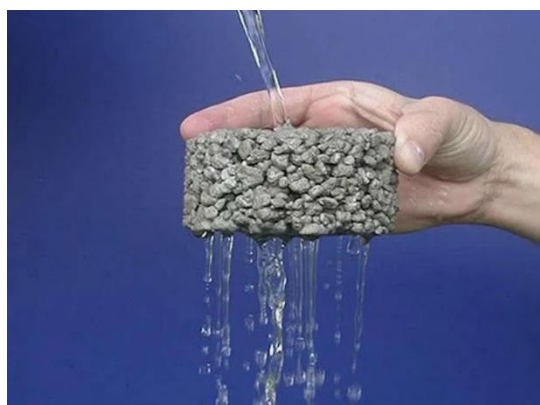
شکل ۲) نمونه بتن متخلخل با قابلیت عبور دهی آب
