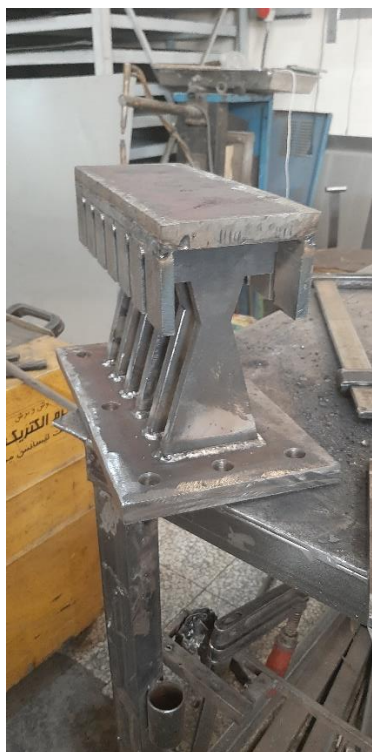
شکل ۶: میراگر تسلیمی آماده شده جهت نصب در قاب خمشی بتنی.
