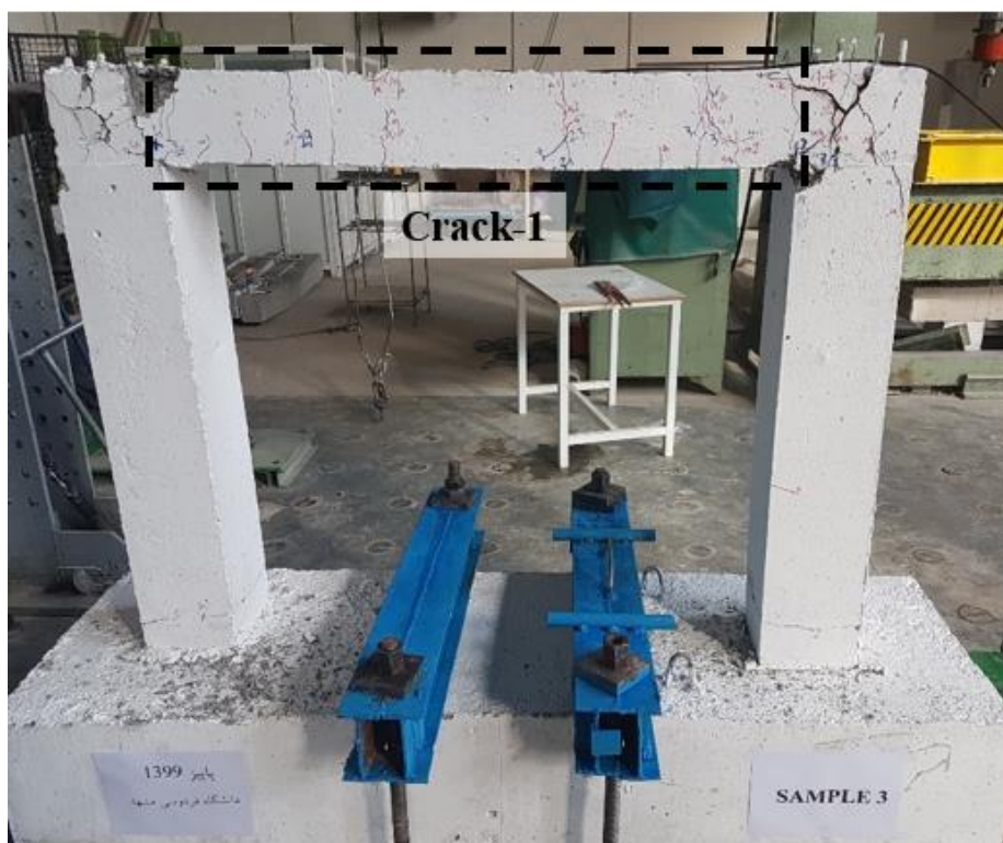
شکل ۱۱: نحوه ترک خوردگی نمونه Conc-F-3 بعد از آزمایش.
