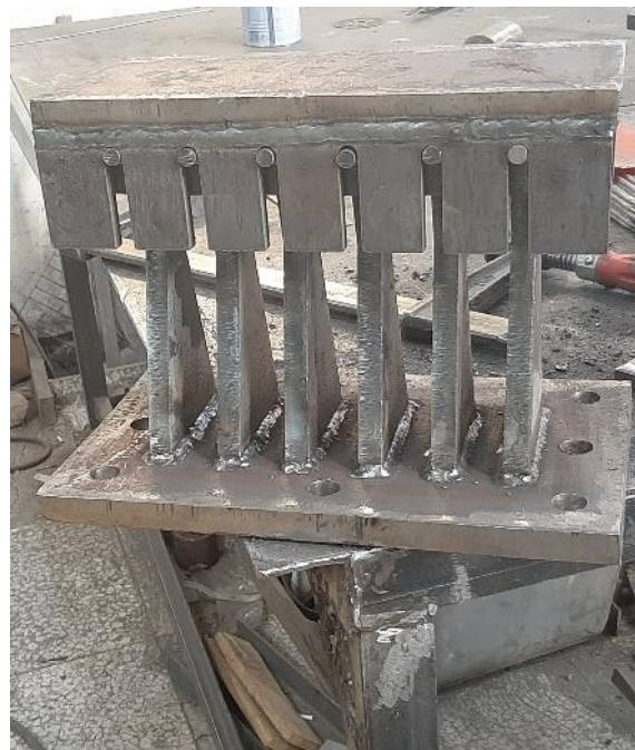
شکل ۶: میراگر تسلیمی آماده شده جهت نصب در قاب خمشی بتنی.
