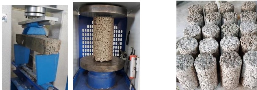
شکل ۷. نمونه‌های آزمایش مقاومت فشاری پس از خروج از آون شکل ۸. نمونه بتن تحت آزمایش مقاومت فشاری و خمشی
