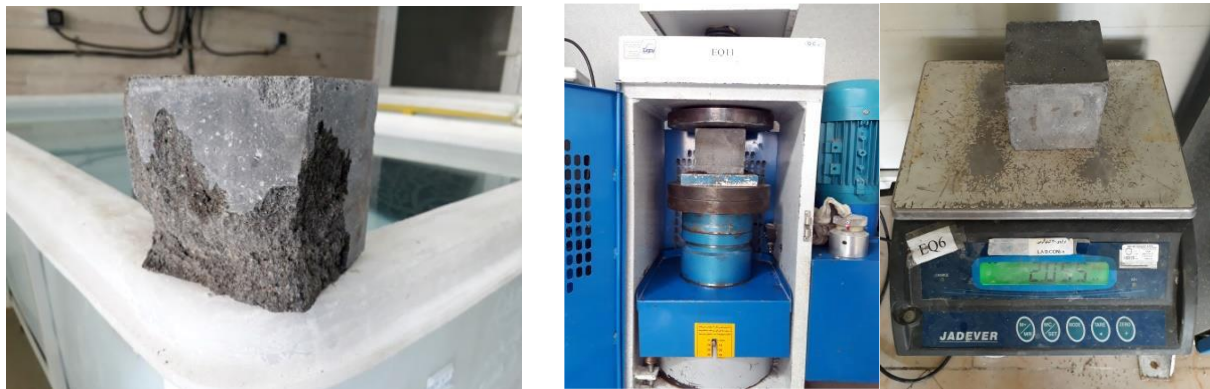
شکل ۹ - توزین آزمونه‌ها و قرارگیری زیر جک مقاومت فشاری (راست) - گسیختگی از چهار جهت آزمونه (چپ)
