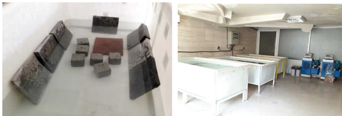
شکل ۴ - محل انجام آزمایش‌ها در انجمن صنفی تولیدکنندگان بتن آماده (راست) - عمل‌آوری در حوضچه (چپ)
