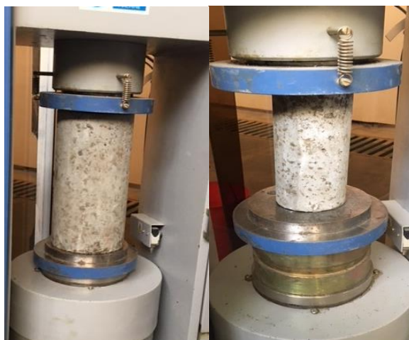
شکل ۵- نحوه قرارگیری آزمونه‌های استوانه‌ای درون دستگاه مقاومت فشاری
