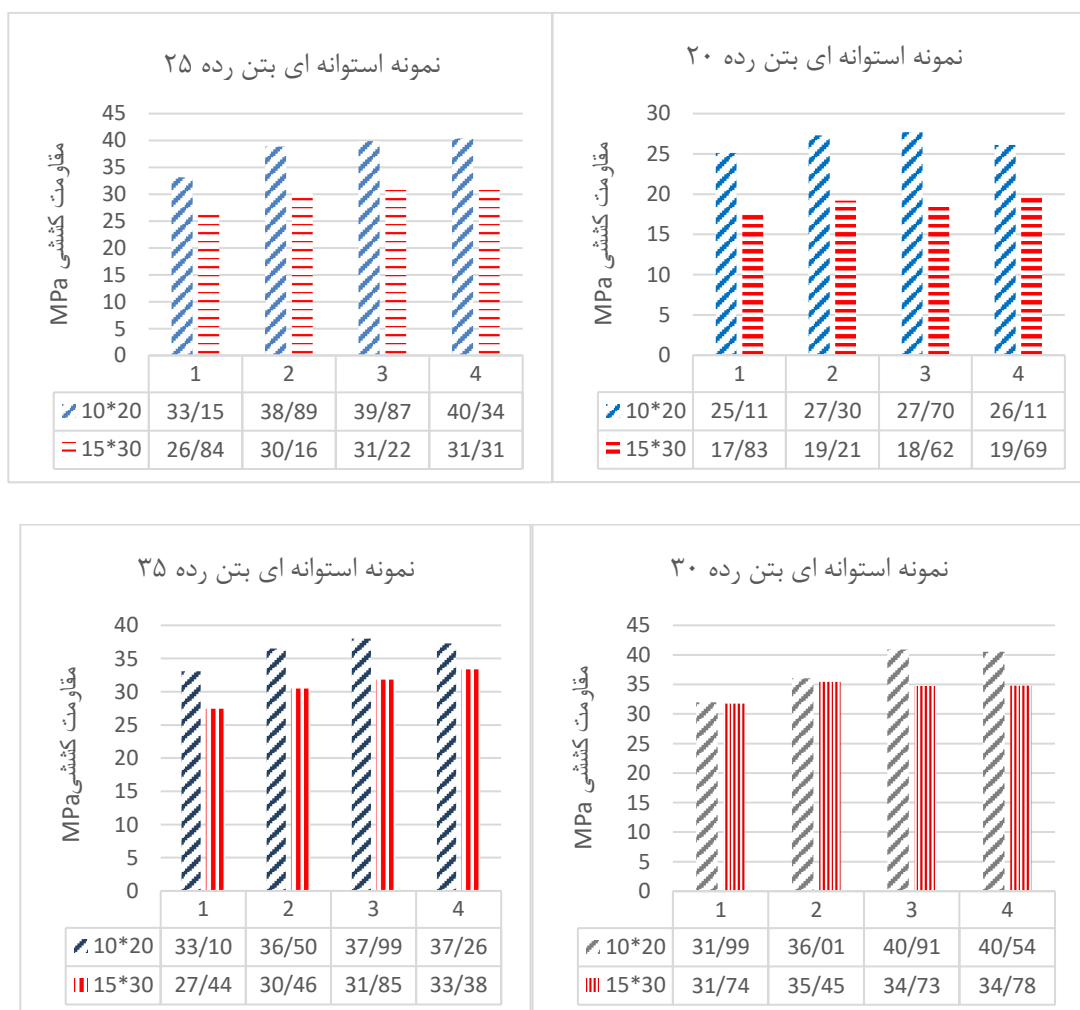
شکل ۶- نمودار مقاومت کششی آزمون‌های استوانه‌های بتن ۲۰، ۲۵، ۳۰ و ۳۵ مگاپاسکال
