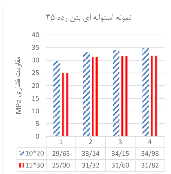
شکل ۴- نمودار مقاومت فشاری آزمونه‌های استوانه‌ای بتن ۲۰ و ۲۵ و ۳۰ و ۳۵ مگاپاسکال
