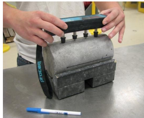
شکل ۱- نحوه‌ی اندازه‌گیری مقاومت الکتریکی سطحی آزمونه
