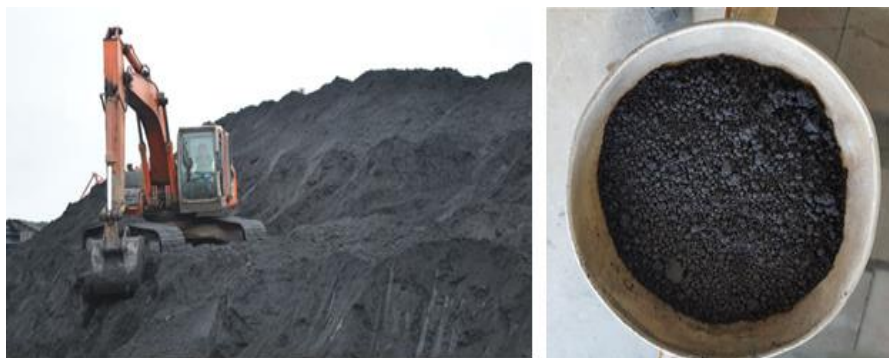
شکل ۱- کنسانتره آهن: الف) نمونه کنسانتره آهن ب) دیو کنسانتره آهن در کارخانه
