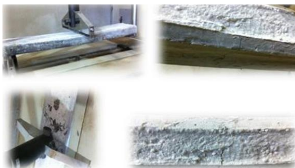
شکل ۱۰- نحوه شکست و الگوی ترک نمونه‌های تیر بتنی ساخته شده با سه طرح اختلاط
